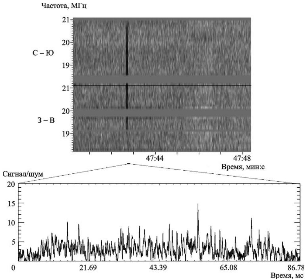
**Рис. 1.** Тонкая структура SED (шторм F, сеанс 4.12.2007 г.): спектрограмма молнии с разрешением 6 мс (верхняя панель); профиль молнии с времененным разрешением 45 мкс (нижняя панель). Верхняя часть спектрограммы получена с помощью антенны Север-Юг (С-Ю), а нижняя – с помощью антенны Запад-Восток (3-В). На нижней панели сигнал, превышающий уровень  $3\sigma$ , состоит из большого числа отдельных узких пиков, соотношение сигнал/шум для некоторых достигает 15
