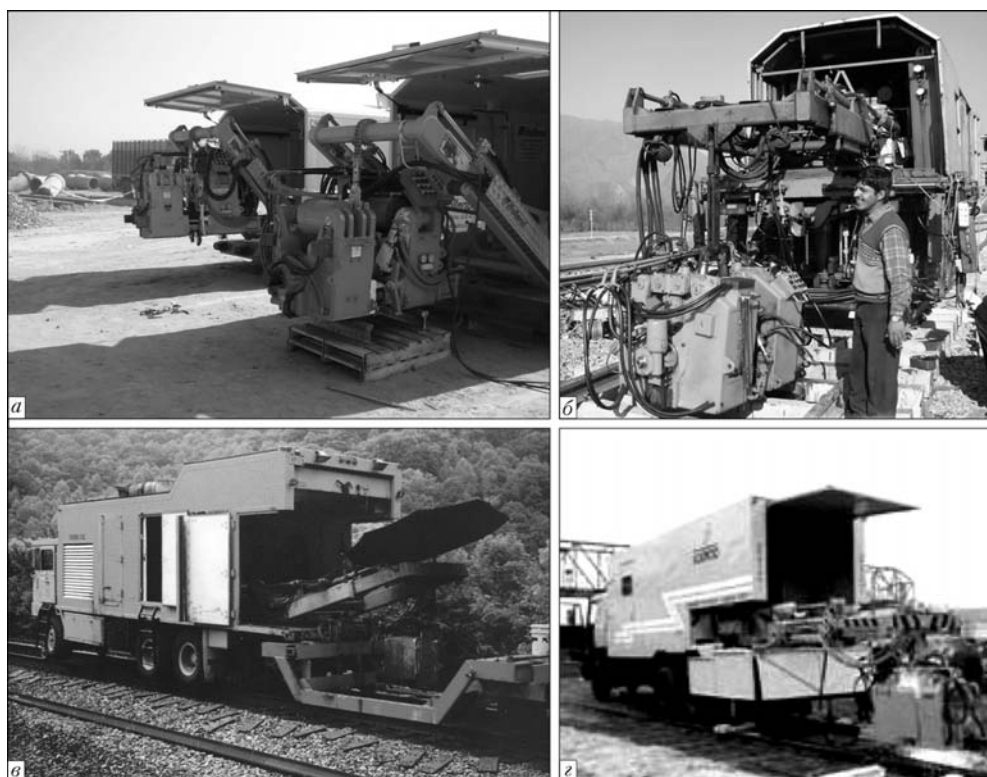
Рис. 11. Передвижные рельсосварочные комплексы: а — «Holland»; б — «Plasser»; в — «Norfolk»; г — КСМ 005
