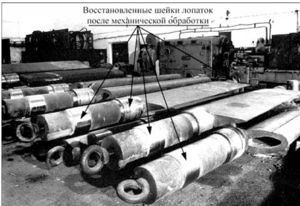
Рис. 13. Лопатки направляющего аппарата гидротурбины крупнейшей в Европе Волжской ГЭС с восстановленными сваркой взрывом шейками
