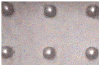
Рис. 5. Сформовані за розробленою технологією індієві стовпчики ( \varnothing 11,5 мкм)
