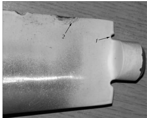
Рис. 1. Коррозионно-усталостное разрушение (1) поверхности лопатки из стали 14X17H2 в процессе эксплуатации и хрупкое разрушение в районе забоин (2) при аварийном разрушении
