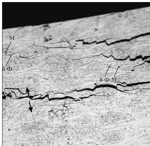
Рис. 4. Смещение локальных участков металла (указаны стрелками), подтверждающих причины вспучивания поверхности в местах образования вздутий, X100
