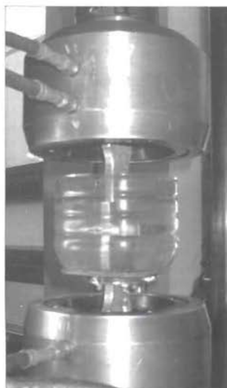
Рис. 2. Образец таврового сварного соединения стали 10ХСНД в процессе испытания в коррозионной среде
