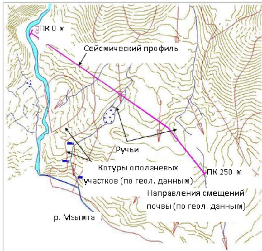
Рис. 1. Фрагмент плана участка режимных наблюдений в районе северных порталов тоннельного комплекса № 3 совмещенной дороги «Адлер - Красная поляна»
