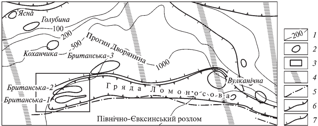
Рис. 1. Британська площа на частині Карти фонду структур Чорного та Азовського морів (за матеріалами ТЦ ДГП «Укргеофізика», зі змінами авторів): 1 — ізобати глибини моря; 2 — локальні структури; 3 — Британська площа; 4 — глибинні розломи та порушення; 5 — субмеридіональні глибинні розривні порушення; тектонічне районування; 6 — виступи, вали; 7 — прогини, западини
