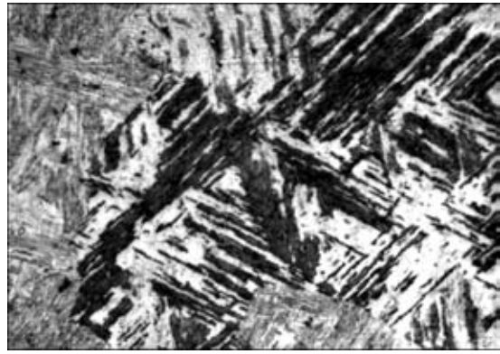
Рис. 1. Микроструктура стали 03X12H8M2ГСТ (прототип металла шва), \times 500
