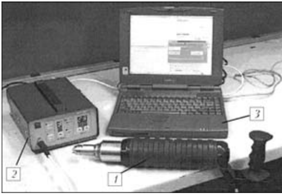
Рис. 2. Оборудование мощностью 0,3 кВт для высокочастотной механической проковки сварных соединений металлоконструкций: 1 — ручной инструмент с пьезокерамическим излучателем; 2 — ультразвуковой генератор; 3 — компьютер
