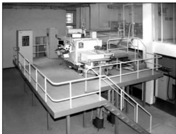
Рис. 5. Электронно-лучевая установка L-5
