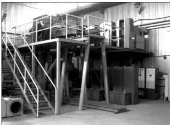
Рис. 9. Специализированная электронно-лучевая установка для плавки металлов и сплавов
