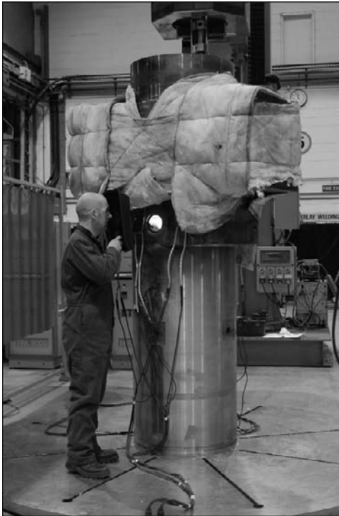
Технология наплавки НВГ с использованием горячей проволоки при ТИГ-процессе от компании «Fronius» обеспечивает 40 % экономии времени для компании FMC при производстве сложных клапанных блоков
