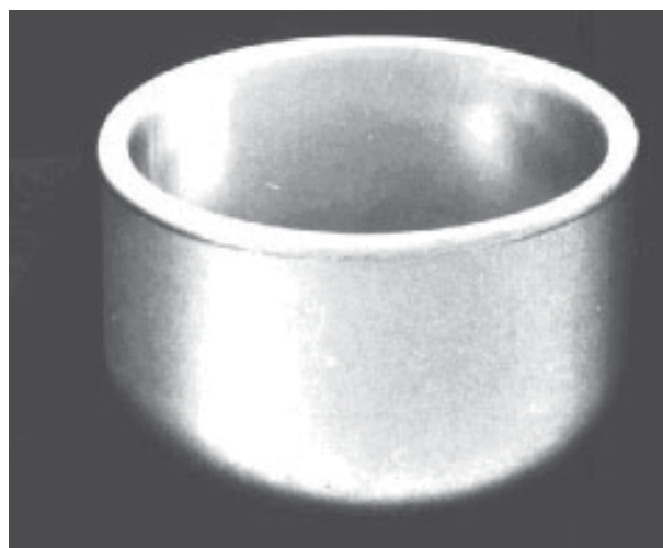
Рис. 1. Молибденовый тигель с защитным покрытием для варки стекла в оптическом стекловарении.
