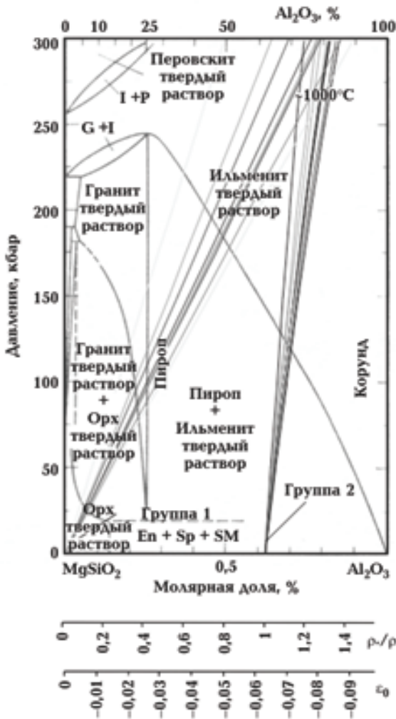
Рис. 5. Изотермическое сечение ( T \sim 1000^\circ\text{C} ) фазовой диаграммы \text{MgSiO}_3\text{—Al}_2\text{O}_3 . Обозначения: Орх — ортопироксен, En — энстатит, Sill — силлиманит, G — гранат, I — ильменит, P — перовскит, Sp — шпинель (автор Лин-гун Лиу) [Жарков, 1983]; p = p — раствор. Остальные условные обозначения см. на рис. 3.
