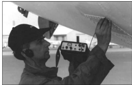
Рис. 4. Контроль обшивки фюзеляжа в зоне откидной рампы самолета АН-12 с помощью дефектоскопа ЛЕОТЕСТ ВД.3.01
