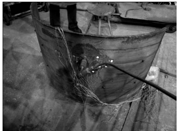
Рис. 1. Общий вид фрагмента корпуса теплообменника, подверженно-го низкотемпературному сероводородному растрескиванию
