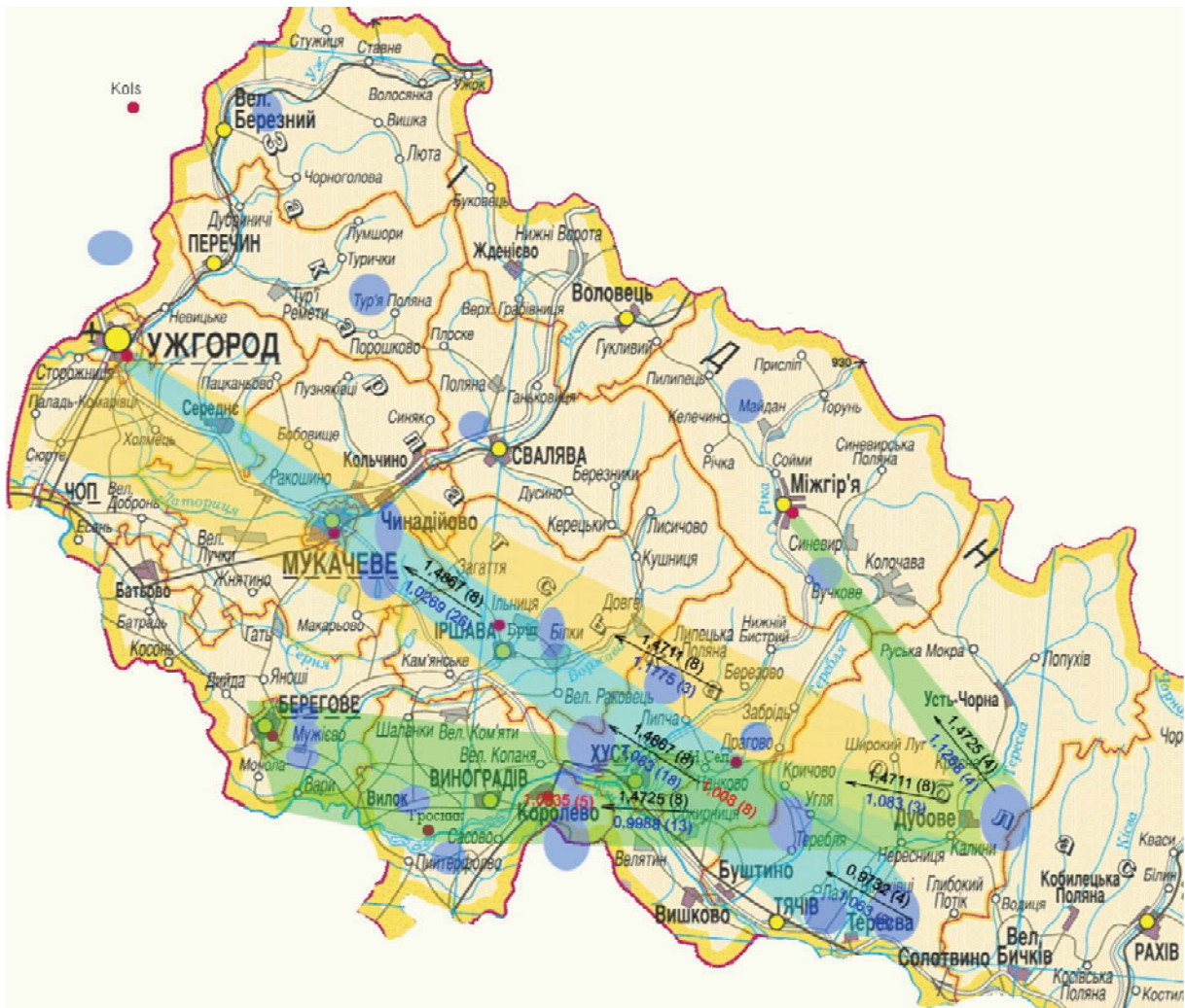
Рис. 2. Приклад секторів із близькими швидкостями поширення P -хвиль від джерела до сейсмостанцій для першого, другого і третього шарів
