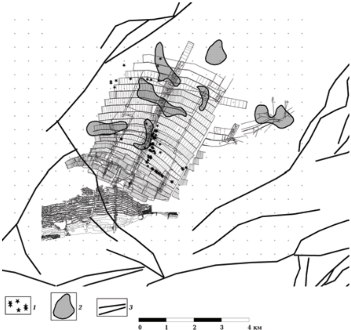
Рис. 3. Схема сопоставления выкопировки из плана горных работ по пласту m_3 шахты им. А. Ф. Засядько с основными тектоническими нарушениями: 1 — газодинамические явления, 2 — прогнозные зоны скопления метана [Гончаренко и др., 2007], 3 — тектонические нарушения.
