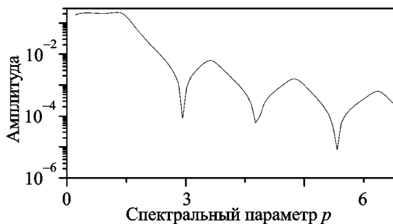
Рис. 3. Затухание амплитуды коэффициентов разложения моды HE_{11} по модовому базису
