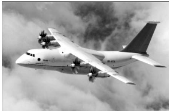
Рис. 4. Военно-транспортный самолет короткого взлета и посадки Ан-70 в настоящее время не имеет аналогов в мире
