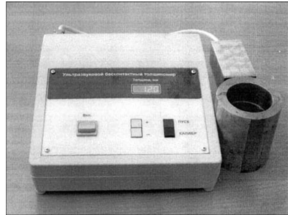
Рис. 5. Двухпроцессорный ЭМА толщиномер для измерений по «черновой» поверхности или по лакокрасочному покрытию толщиной до 3 мм, в котором реализованы линейно-частотная и оптимальная фильтрации
