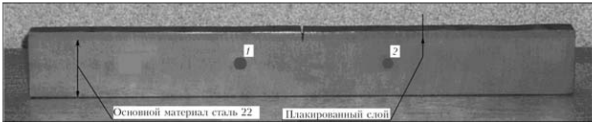
Рис. 3. Образец из стали 22К с надрезом: 1, 2 — места установки датчиков
