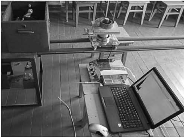
Рис. 1. Установка для проведения эксперимента по изучению эффекта увеличения комптоновского рассеяния \gamma -квантов при прохождении их вдоль металлической поверхности
