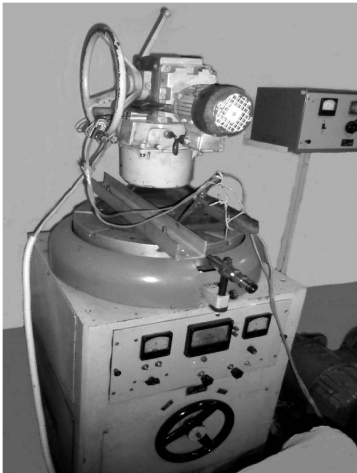
Рис. 4 Вибростенд с закрепленным на нем электроприводом для выполнения испытаний оборудования в лабораторных условиях
