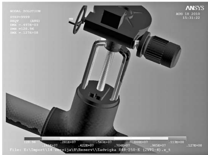
Рис. 5. Модель для расчета на сейсмостойкость задвижки с электроприводом
