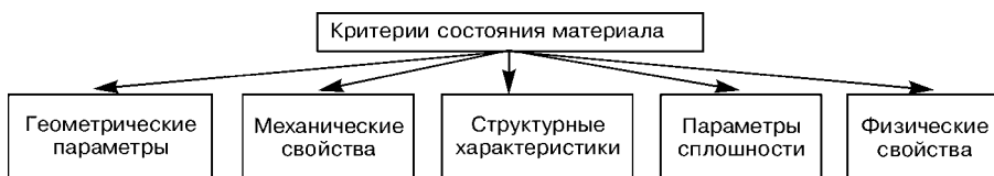
Рис. 3. Критерии, определяющие состояние металла сварной конструкции
