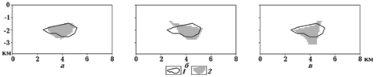
Рис. 4. Результаты решения смешанной обратной задачи гравirazведки, соответствующие плотности 0,3 \text{ г/см}^3 подобранного объекта. Условные обозначения те же, что и на рис. 3.
