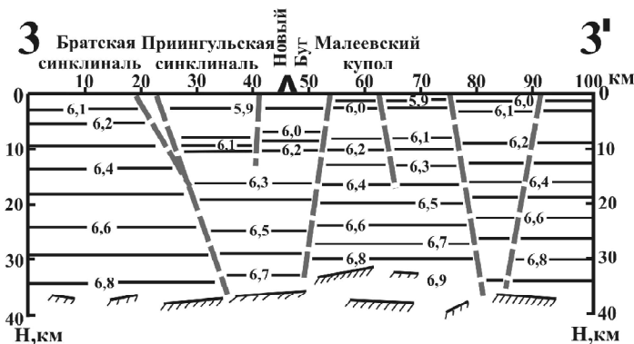
Рис. 4. Модели распределения скорости распространения упругой волны продольной поляризации вдоль профиля 3–3', синтезированные по материалам ГСЗ, выполненным по профилям XXIV, XXV и XXXIV, а также геотраверсам IV и VIII: 1 – изолинии скорости (км·с -1 ), 2 – разломы, 3 – поверхность М
