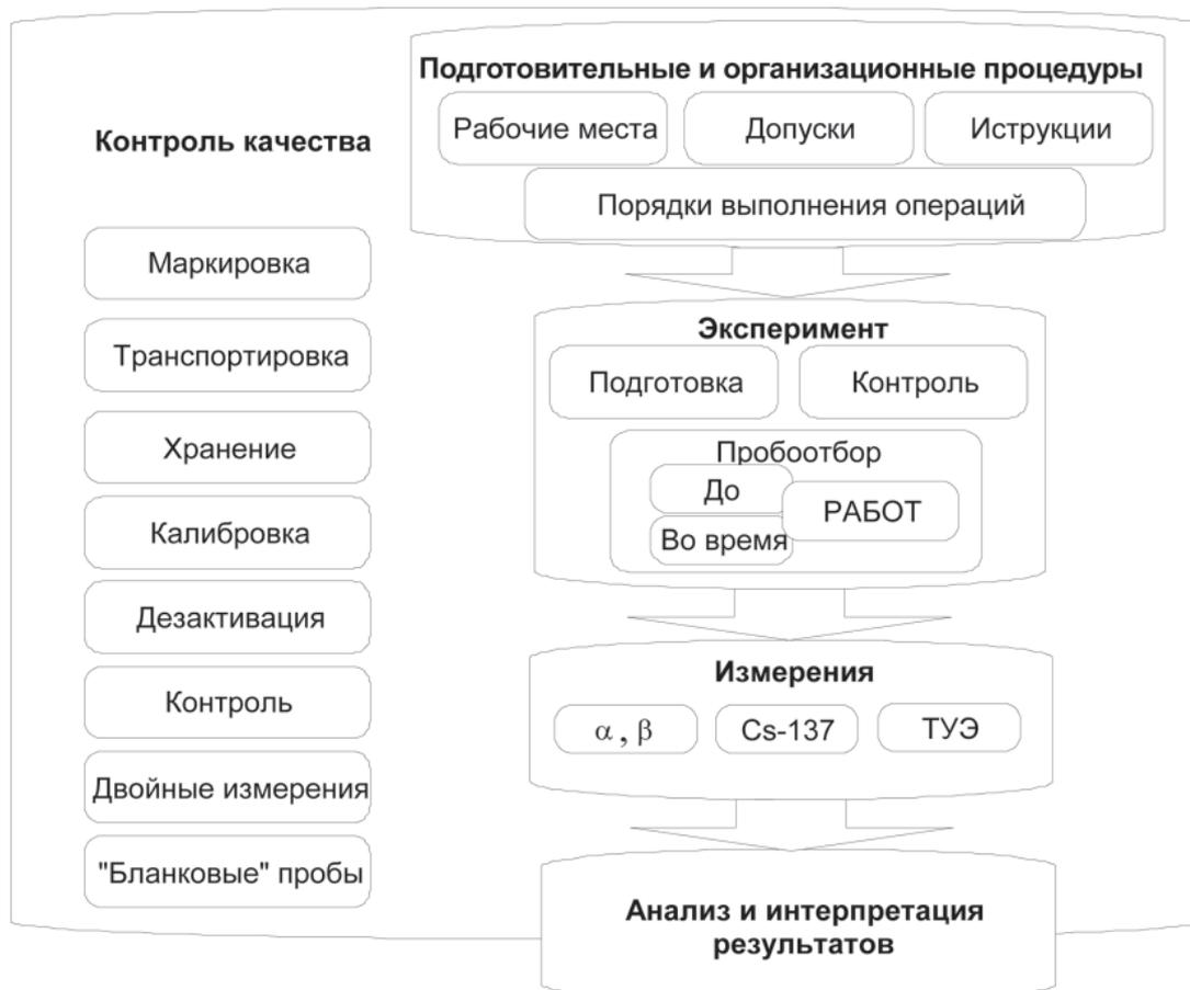
Рис. 1. Структура специальной программы мониторинга радиоактивных аэрозолей
