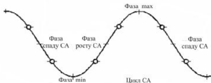
Рис. 1. Схема виділення чотирьох фаз в 11-річних циклах сонячної активності
