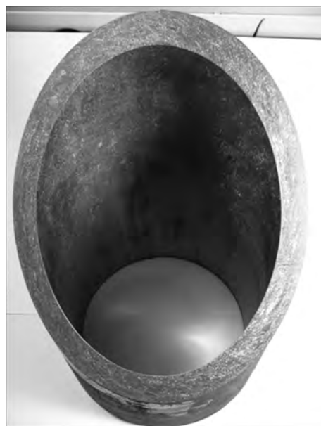
Рис. 7. Макроструктура горячекатаной трубы 114×15 мм из титанового сплава BT20
