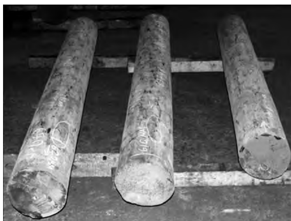
Рис. 5 Кованные прутки из титанового сплава BT20 диаметром 140 мм
