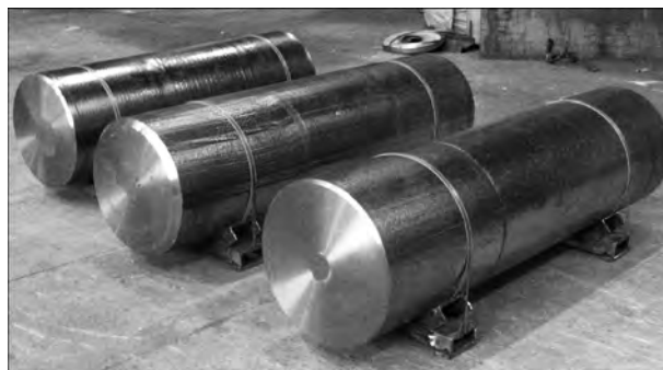
Рис. 1. Слитки титанового сплава VT20 диаметром 500 мм
