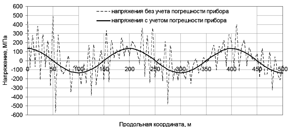
Рис. 4. Напряжения в трубопроводе, геометрия которого замерена со случайной погрешностью, распределенной по нормальному закону.
