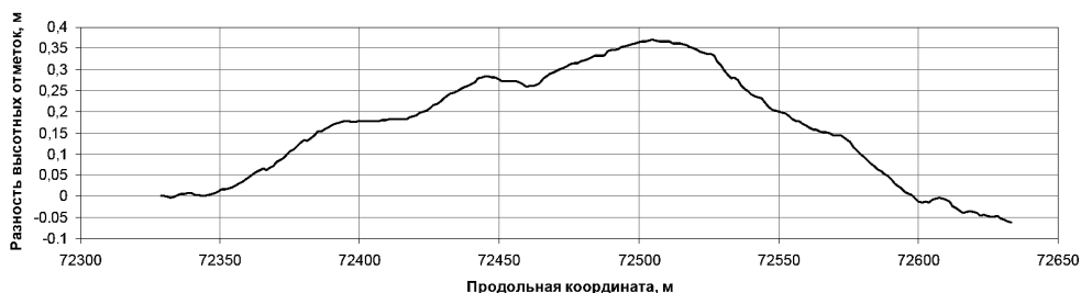
Рис. 8. Разность высотных отметок по результатам двух проходов геодезического поршня.
