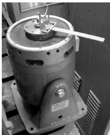
Рис. 2. Крепление образца к платформе вибростенда.
