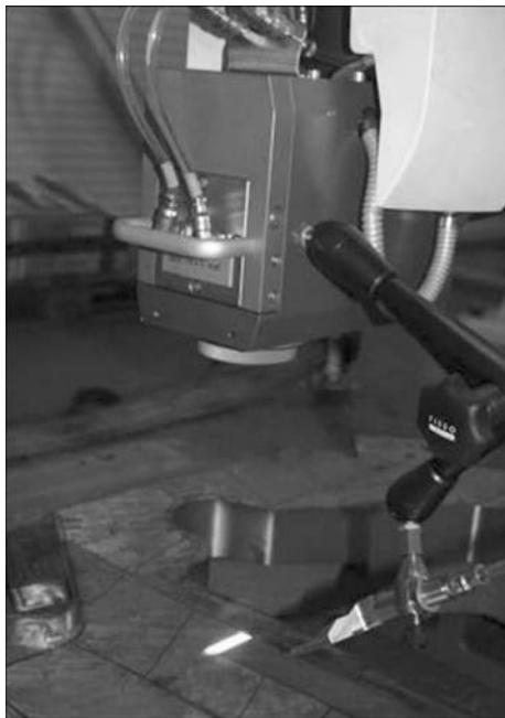
Лазерное термоупрочнение пресс-формы (Erlas Hard+Clad)
