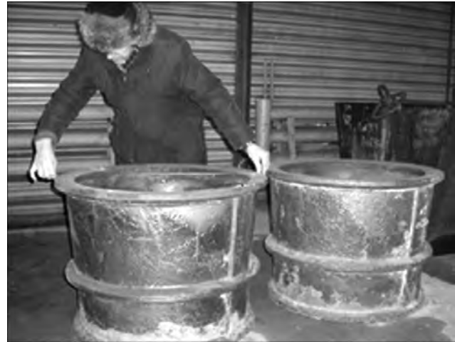
Рис. 3. Крупногабаритные фасонные отливки ЦЭШЛ массой 0,6 т из стали 15X12H2MBФAB (ЭП 517)
