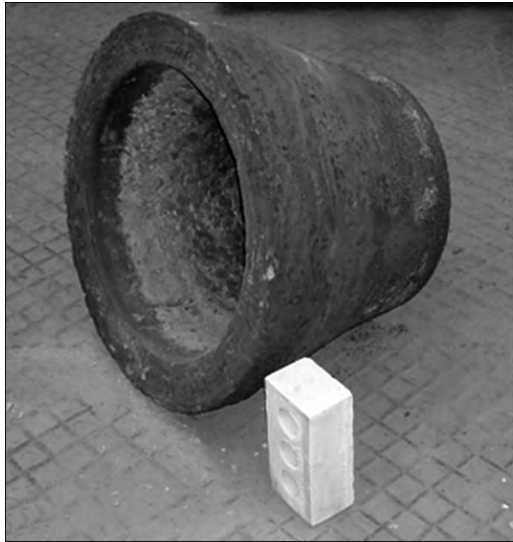
Рис. 2. Полая отливка ЦЭШЛ массой 0,5 т из стали 13X11H2B2MФ (ЭИ 961)
