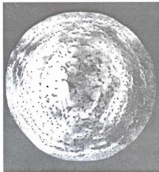
Рис. 3. Центральная сегрегация в заготовке диаметром 152 мм из суперсплава (ESR)
