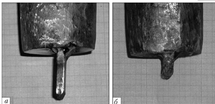
Рис. 2. Вид торца электрода до (а) и после (б) выплавки флюса
