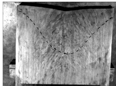
Рис. 2. Сечение слитка ЭШП диаметром 500 мм, полученного при высокой скорости плавления: штриховой линией обозначен контур жидкой ванны
