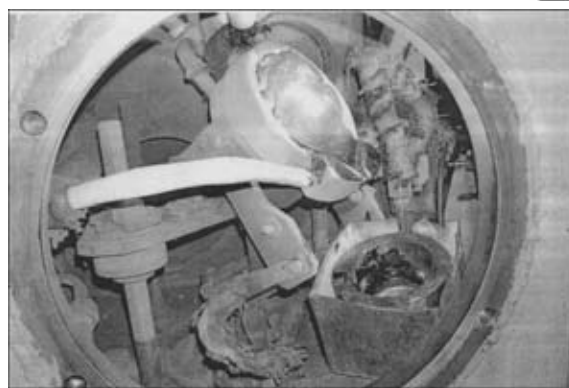
Рис. 2. Плавильная камера с тиглем и изложницей для переплава прессованной заготовки
