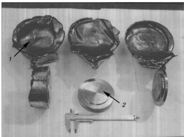
Рис. 3. Отлитый (1) и обработанный (2) образцы из технического титана диаметром 120 мм и высотой 7 мм
