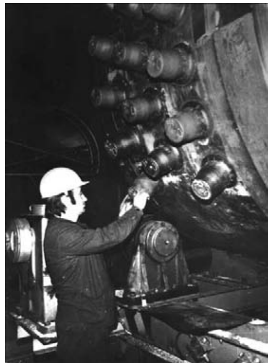
Рис. 9. Заготовки патрубков, выплавленные методом ЭШЛ непосредственно на корпусе сосуда
