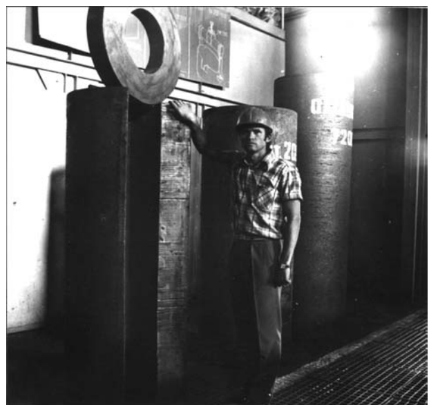
Рис. 4. Поле слитки из стали 20 и 12Х18Н10Т (диаметр 710 мм, толщина стенки 170 мм), изготовленные методом ЭШЛ, для обечаек сосудов высокого давления
