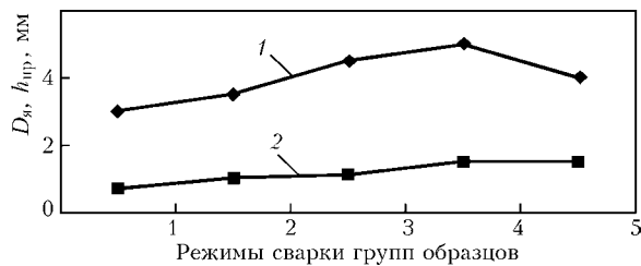
Рис. 4. Влияние режима сварки (см. табл. 1) на параметры точечного шва D_{я} (1) и h_{кр} (2)
