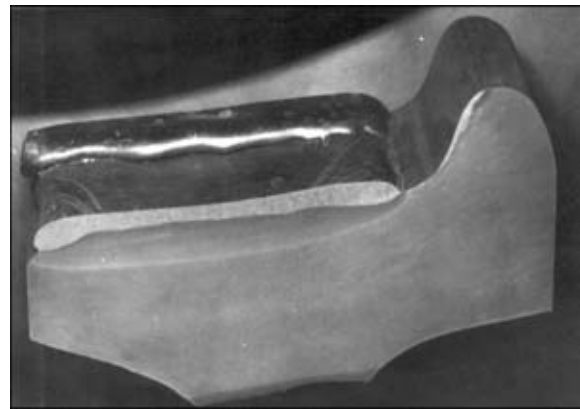
Рис. 3. Фрагмент обода колеса с наплавочной поверхностью
