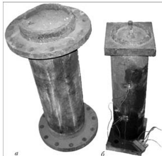
Рис. 6. Экспериментальные образцы размером 219×8 (а) и 168×7 (б) мм
