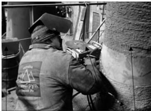
Рис. 4. Наплавка вала полуавтоматом ПШ 107В: 1 — блок независимого питания; 2 — полуавтомат; 3 — наплавленная поверхность вала дробящего конуса
