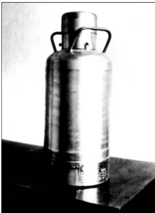
Рис. 2. Сварной транспортно-технологический контейнер из сплава Э110 вместимостью 20 л
