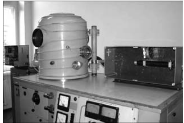
Рис. 4. Внешний вид установки для исследования линейного расширения металлов
