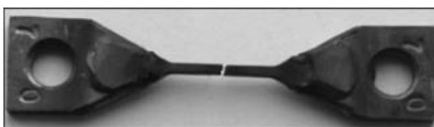
Рис. 3. Внешний вид образца из сплава ЧС-70 после высокотемпературных испытаний
