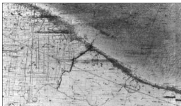
Рис. 1. Характерный вид горячей трещины, возникшей в ОШЗ и распространившейся в металл шва (X100)
