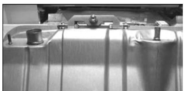
1101015-20 в составе поточной линии. Толщина свариваемых деталей может быть в пределах 0,8...1,5 мм.
