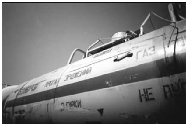
Рис. 3. Железнодорожная цистерна после опрокидывания
