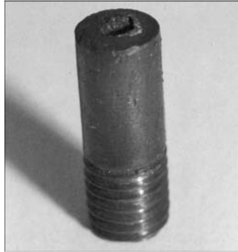
Рис. 3. Изношенный токоподводящий мундштук из экспериментального порошкового материала
