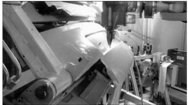
Рис. 5. Лазерная пайка кабины автомобиля
